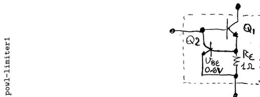
Démontrer que le circuit se comporte comme un transistor équivalent à  $Q_1$  si  $i_{E1} < 0.6\text{ A}$ , et comme une source de courant (limiteur) si  $i_{E1} = 0.6\text{ A}$ .
